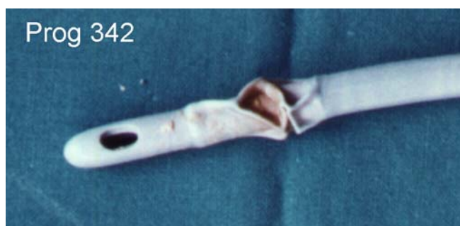
Foto 2 Catetere (prog 342): particolare della punta dopo 35 giorni.
